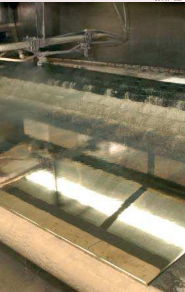
Refletindo: a aplicação da prata faz o vidro se tornar espelho
